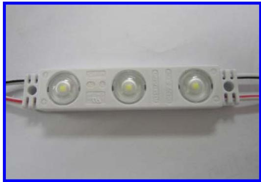
**Mini 3 Crystal** è un modulo dalle altissime prestazioni, prodotto con la tecnica dello stampaggio a caldo. Sui LED è applicata una speciale lente plastica di diffusione della luce, che non perde le sue caratteristiche nel tempo. L'angolo luminoso di 160° lo rende ideale per lettere scatolate e cassonetti di profilo da 80 a 200 mm.
