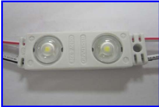
**Mini 2 Crystal** è un modulo dalle altissime prestazioni, prodotto con la tecnica dello stampaggio a caldo. Sui LED è applicata una speciale lente plastica di diffusione della luce, che non perde le sue caratteristiche nel tempo. L'angolo luminoso di 160° lo rende ideale per lettere scatolate e cassonetti di profilo da 80 a 200 mm.
