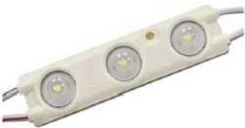
Il modulo **MAX 3 Crystal** utilizza il nuovo LED 2835, molto luminoso e dal consumo contenuto. Realizzato sempre con la tecnologia dello stampaggio a caldo, con l'applicazione di una speciale lente plastica per diffondere uniformemente la luce. L'angolo luminoso di 160° che lo rende ideale per lettere scatolate e cassonetti di profilo da 60 a 120 mm.
